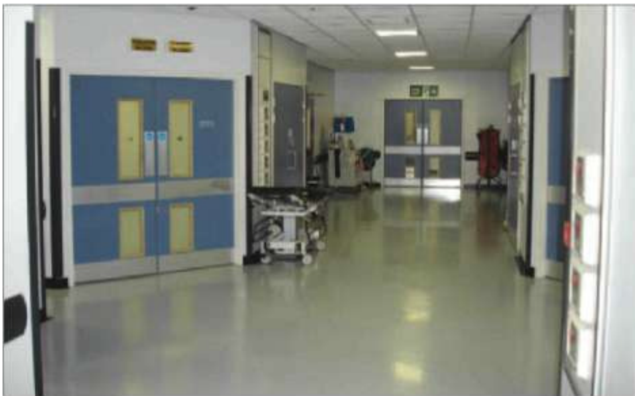
Figura 11 Ieșire cu spațiu suficient pentru manevrarea paturilor și echipamentului
